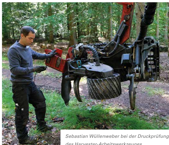
Für den Komatsu-Forest-Service ist unser Meister Sebastian Wüllenweber (links) durch seine Zusatzausbildung und seine Erfahrung im Bereich Forsttechnik bestens ausgebildet. Zusammen mit Harvester-Fahrer Rudi Rauls überprüft er das Spiel von Bolzen und Buchsen des Hydraulikzylinders.
